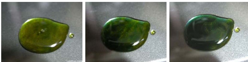
Fig. 13 : Réaction du réactif de Mandelin avec un sel de chlorhydrate de méthamphétamine 18
