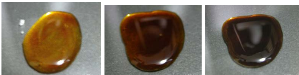
Fig. 12 : Réaction du réactif de Marquis avec un sel de chlorhydrate de méthamphétamine 16
